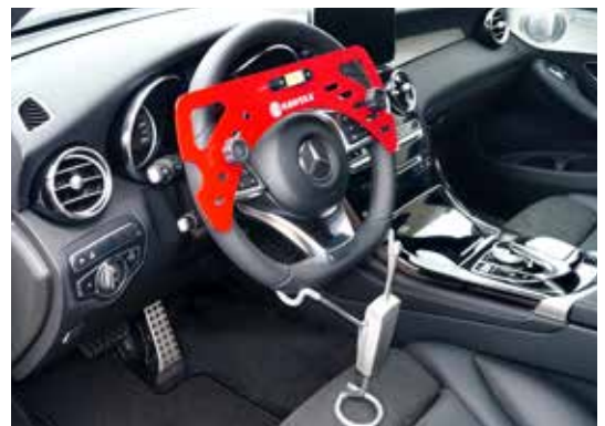
Anbringung der Lenkradeinstellwaage und des Lenkradfeststellers.
